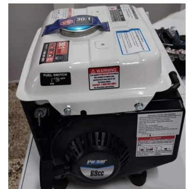
Generador eléctrico a gasolina. Foto: ICLEP
